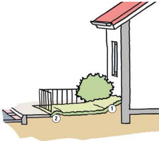
Abb. 21.1 Wenn die Geländeneigung vom Haus zur Straße abfallend verläuft (1), fließt kein Wasser in Richtung Gebäude. Das Grundstück ist jedoch auch so zu gestalten, dass nicht in den öffentlichen Raum entwässert wird (2).
